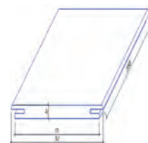
Добірна планка телескопічна 2070x150x16 мм МДФ
