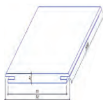
Добірна планка телескопічна 2070x100x16 мм МДФ
