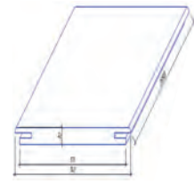
Добірна планка універсальна зі шпугою 2050x140x10 мм ПВХ + МДФ
