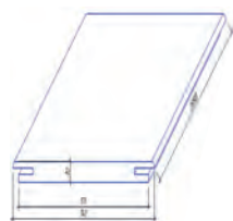
Добірна планка телескопічна 2070x200x16 мм МДФ
